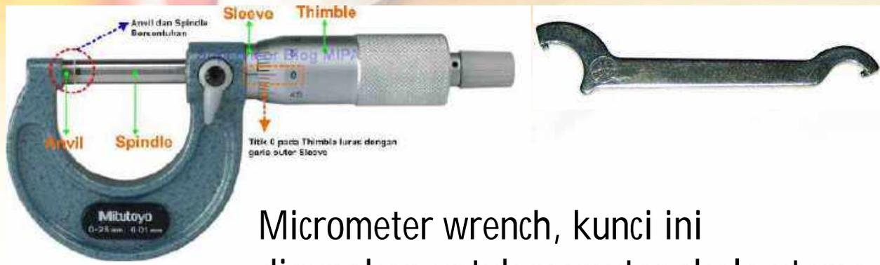
Micrometer wrench, kunci ini digunakan untuk memutar skala utama agar bisa lurus terhadap skala nonius
